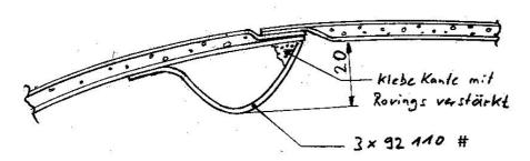
Eine großzügige Ausrundung soll ein Verhaken von Fallschirm oder Gurten an der der Gleitkante selbst verhindern.
