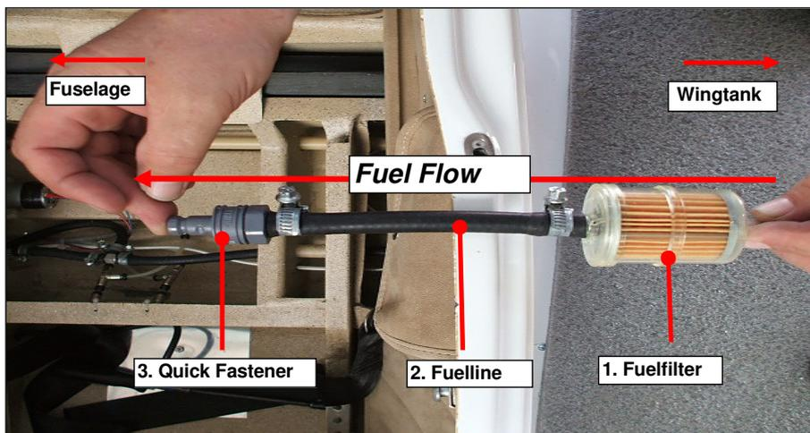
**Falls ein Kraftstoff Schnellverschluss montiert ist, muss in Flussrichtung gesehen zuerst der Benzinfilter und dann der Schnellverschluss montiert werden. Dadurch werden Schmutzpartikel und Fremdstoffe im Filter zurückgehalten und können den Schnellverschluss nicht verstopfen. Diese Überprüfung / Änderung ist an beiden Flächen durchzuführen!**
