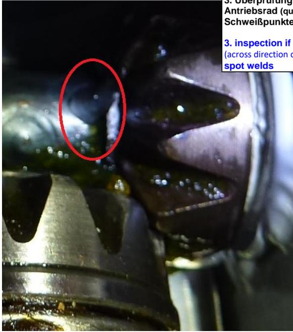
**3. Überprüfung ob das innere Antriebsrad (quer zur Flugrichtung) mit Schweißpunkten gesichert ist**
