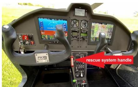
Le système est activé en tirant sur la poignée rouge devant le pilote sous le tableau de bord. La *goupille doit être retirée avant chaque vol*. La goupille doit être remise en place après chaque vol pour éviter un déclenchement intempestif
